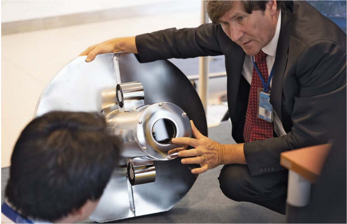
عضو من فريق أجهزة القياس غير المتلف يشرح جهاز رؤية ظاهرة تشيرينكوف الروبوتي.
