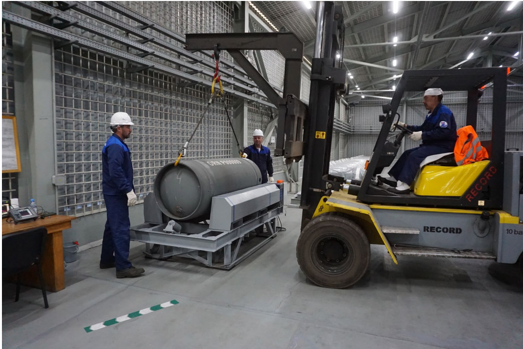
图 B.3. 对原子能机构低浓铀银行满装低浓铀的 30B 型容器进行重新认证。
