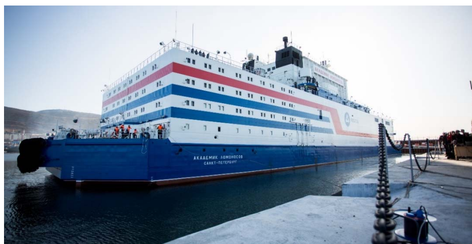
Fig. A-8. La central nuclear Akademik Lomonosov, con dos reactores KLT-40S, se está explotando con fines comerciales desde mayo de 2020 y produce 70 MW(e) en Pevek (Federación de Rusia). (Fotografía: Oficina de Diseño Experimental de Ingeniería Mecánica Afrikantov de Rosatom)
