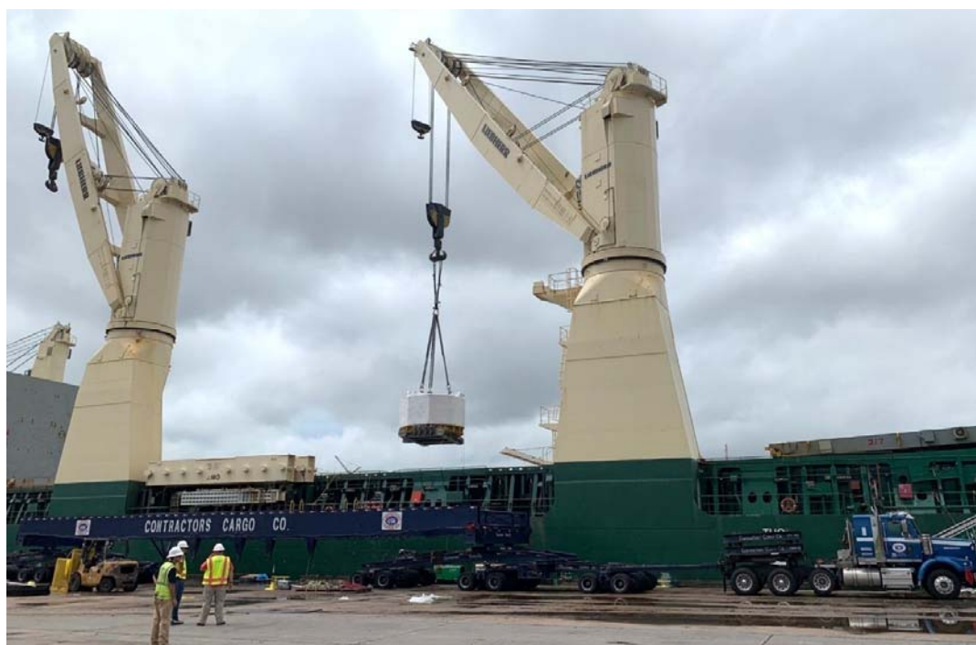
Fig. A-10. Carga del módulo del solenoide central del ITER, de 110 toneladas, en la bodega de un buque de carga general para su traslado desde los Estados Unidos de América hasta el emplazamiento del ITER en Francia. El imán central, de 1000 toneladas y cinco pisos de altura, inducirá 15 millones de amperios de corriente eléctrica en el plasma del ITER para iniciar cada pulso de plasma y lograr la estabilidad vertical del plasma. Para lograrlo, el solenoide central alcanzará una intensidad de campo magnético de 13 teslas, unas 280 000 veces superior a la del campo magnético de la Tierra. (Fotografía: US ITER)
