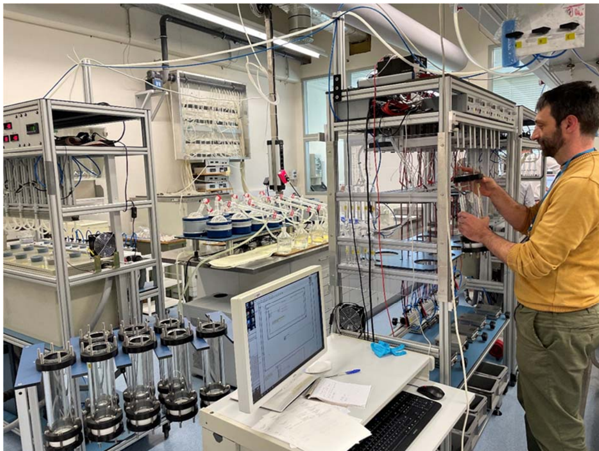
Fig. B.1. Nuevo método de enriquecimiento de tritio basado en la tecnología de las membranas electrolíticas poliméricas sólidas (PEM), con sistema de destilación de fondo (Fuente: OIEA)
