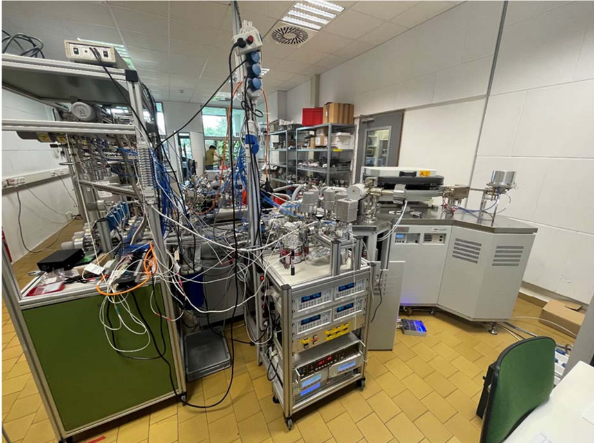
Fig. B.2. Nuevo sistema de espectrómetro de masas de helio 3 de última generación para analizar la tasa de concentración de tritio mediante el método de crecimiento del helio 3 instalado en el Laboratorio de Hidrología Isotópica (Fuente: OIEA)
