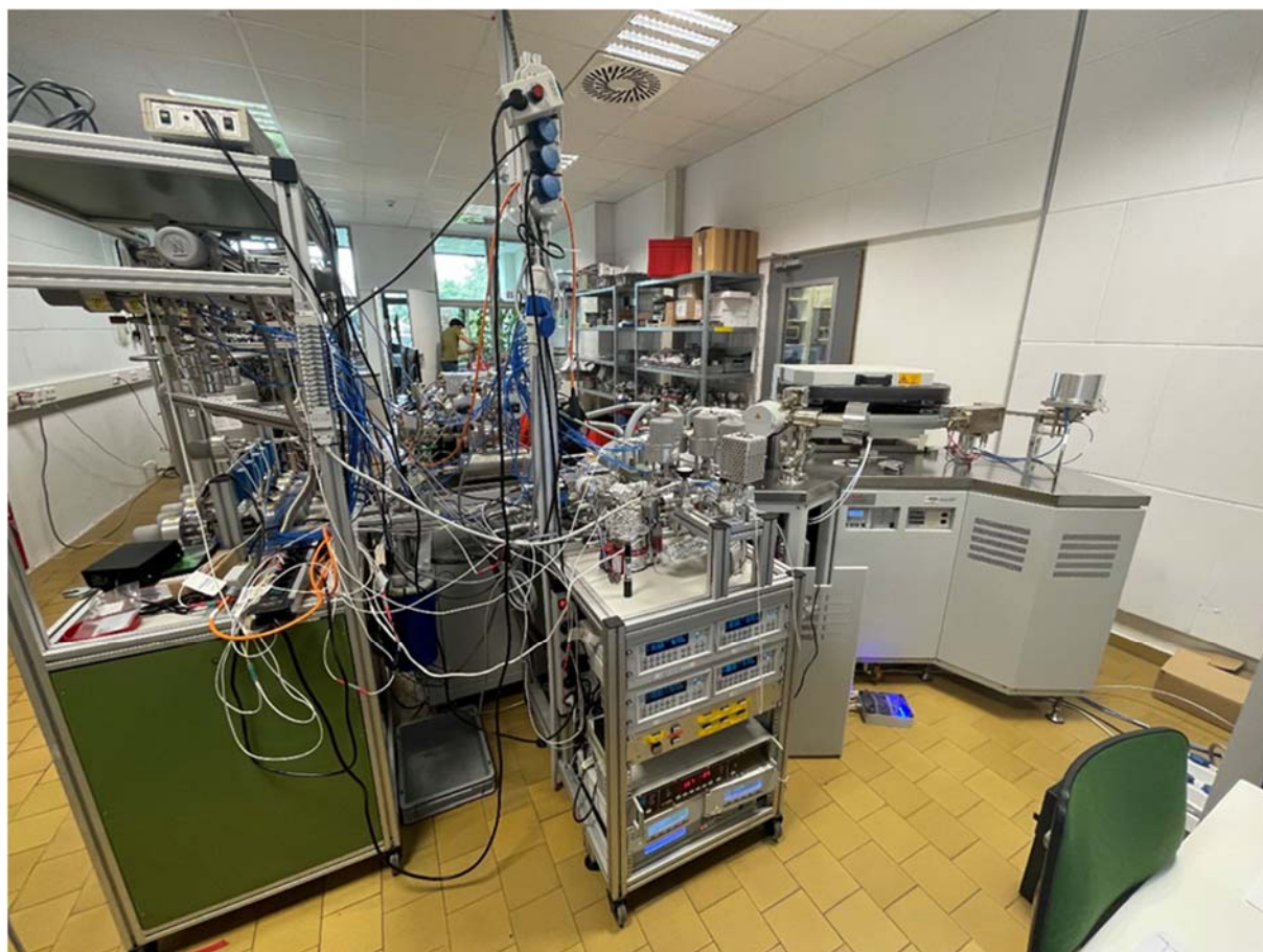
图 B.2. 安装在同位素水文学实验室用于使用氦-3 内生法分析氡浓度的最新氦-3 质谱仪系统（来源：原子能机构）
