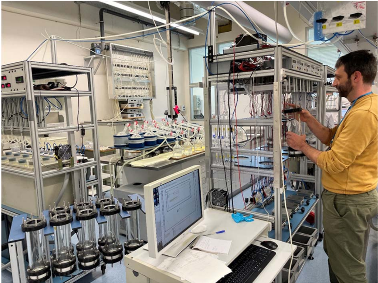
图 B.1. 基于固体聚合物电解膜技术的氙富集新方法，背景为蒸馏系统 (来源：原子能机构)
