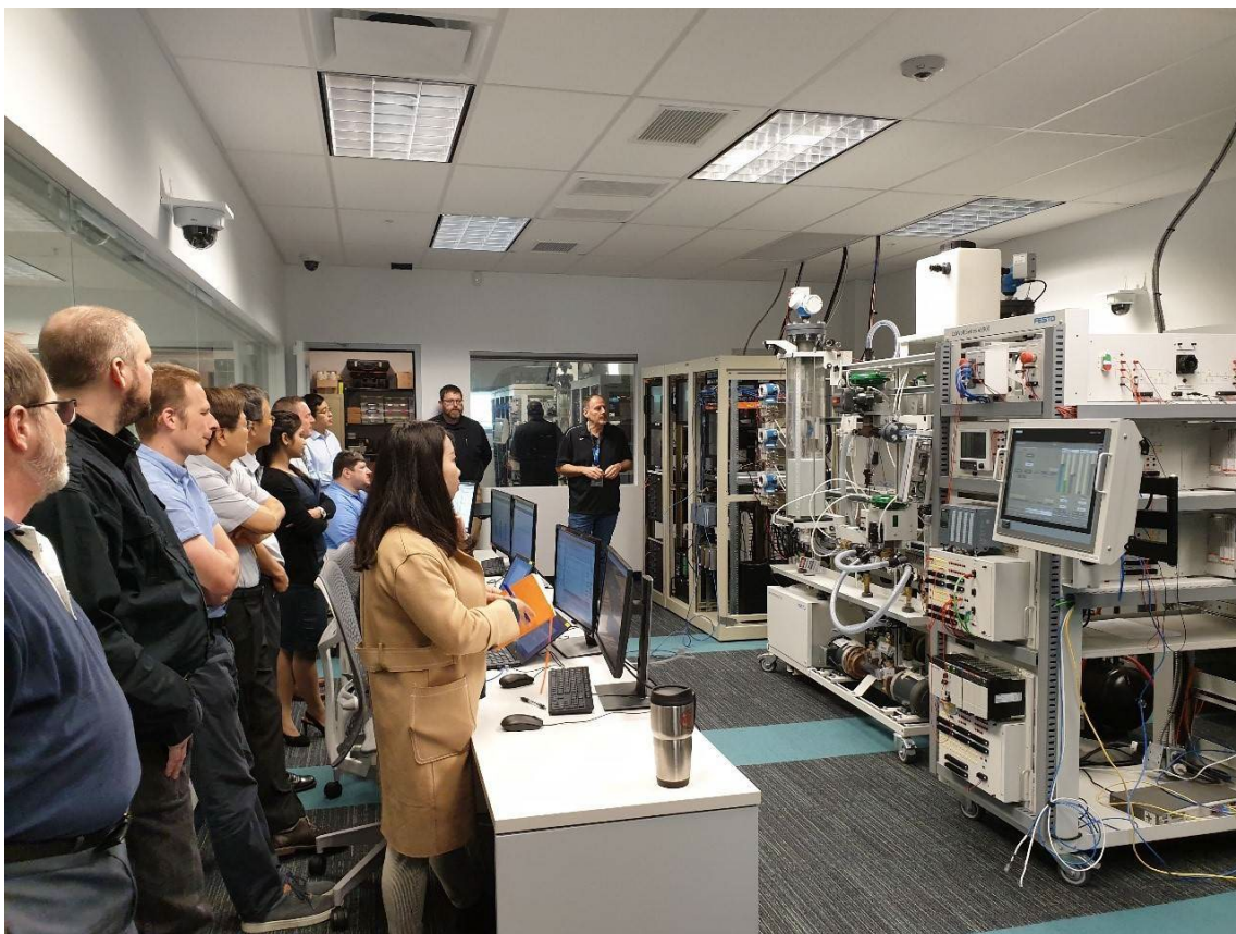
图 1. 协调研究项目参加者正使用模拟机测试各种假想方案，收集所产生的数据集，并评估网络异常检测技术。（照片来源：M. Hewes/原子能机构）
