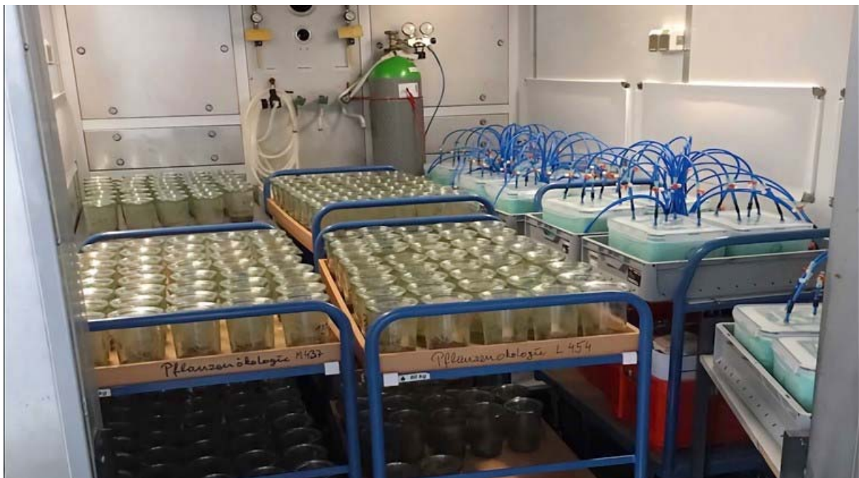
Fig. 2. Incubación del suelo en una cámara climática del laboratorio de edafología de la Universidad Justus Liebig de Giessen (Alemania).
