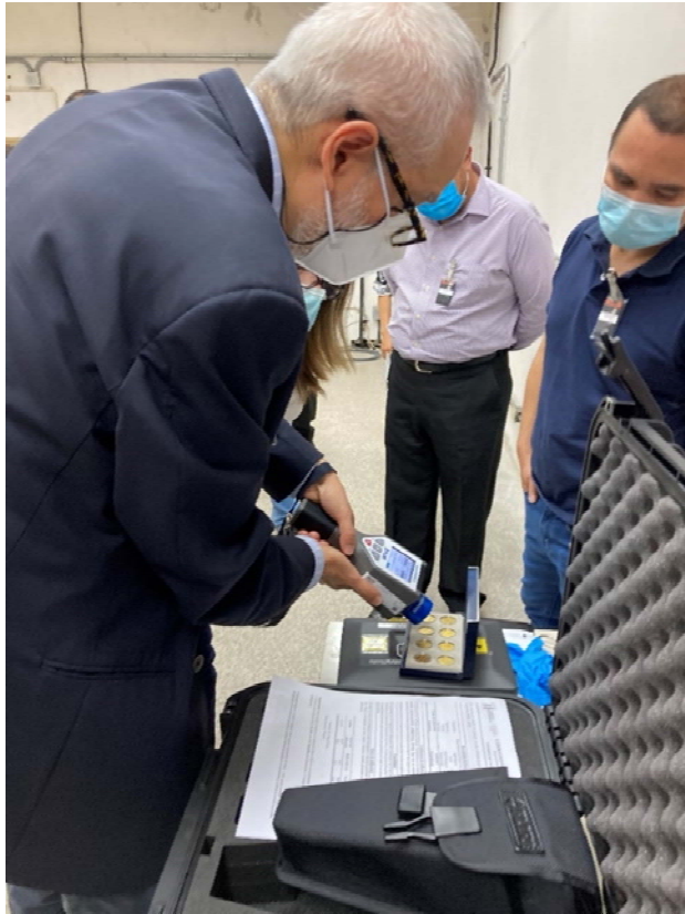
危地马拉“综合能力建设倡议”活动培训 参加者在学习如何使用手持式低分辨率 \gamma 能谱仪 IdentiFINDER R400。 (照片来源：原子能机构工作人员)
