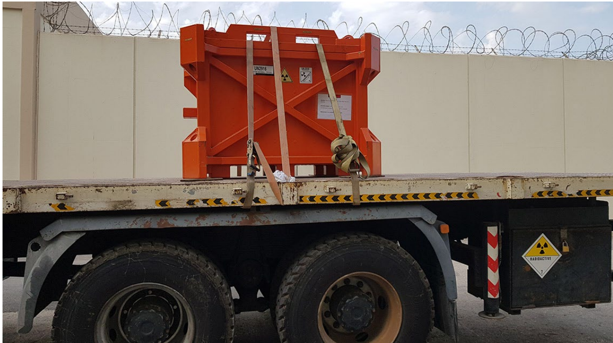
Fuente radiactiva sellada en desuso dentro del contenedor autorizado lista para su transporte internacional. (Fotografía: contratista del OIEA).
