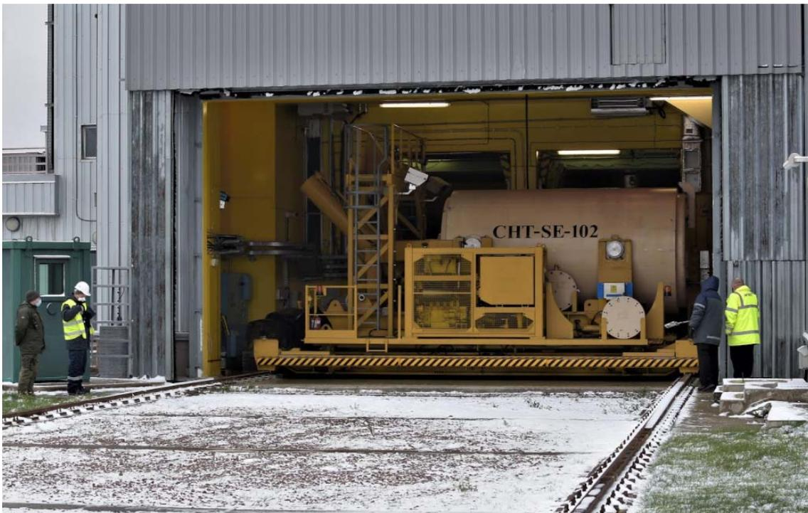
*РИС. С-1. Первый двустенный экранированный пенал, загруженный 93 сборками отработавшего топлива, отбывает с завода по переработке отработавшего топлива для размещения на столетнее хранение. (Фото: Государственное специализированное предприятие «Чернобыльская АЭС»)*
