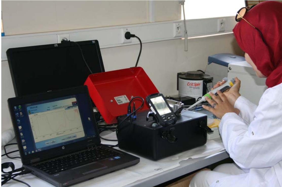
الشكل باء-٣: استخدام تنظيف الطيف بالأشعة تحت الحمراء باستخدام تحويل فورييه لقياس تكوين الجسم. (المصدر: خالد الكاري/المغرب)
