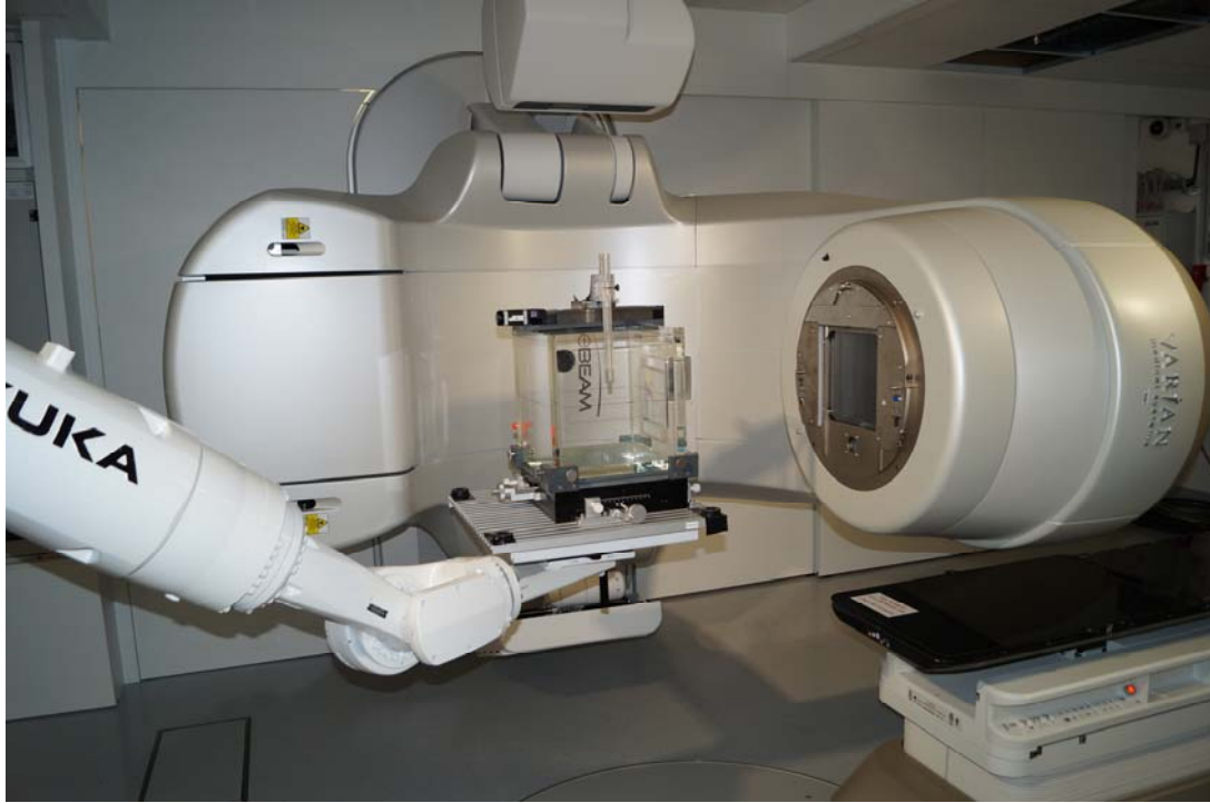
الشكل باء-٥: القيام بمعايرة معجل خطي باستخدام معقد روبوتي في مختبر قياس الجرعات في زايبيرسدورف. (المصدر: الوكالة)
