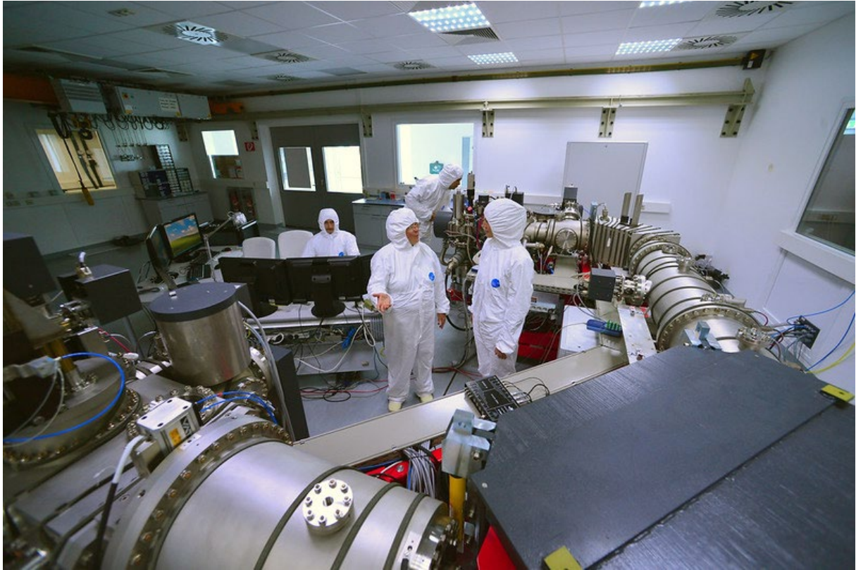
مطياف كتلي للأيونات الثانوية في مختبر العينات البيئية، مختبرات التحليل الخاصة بالضمانات في زايبيرسدورف
