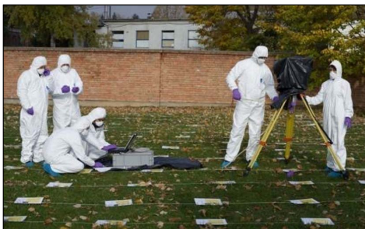
RER7008: Установка гамма-спектрометра in-situ на смоделированном загрязненном участке. Фото: Ш. Тарьян/МАГАТЭ.
