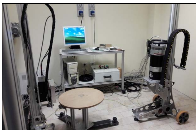
МАТ0002: КТ-визуализация при помощи системы КТ для объектов среднего размера (слева) и системы КТ для крупногабаритных объектов (справа). Фото: М. Грима/Heritage Malta
