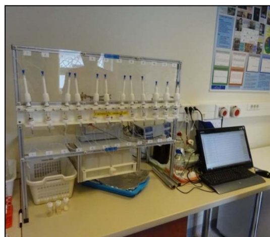
МАТ0002: Датирование углеродом-14 с использованием автоматизированной поточной системы очистки костной ткани АВА. Фото: М. Грима/Heritage Malta
