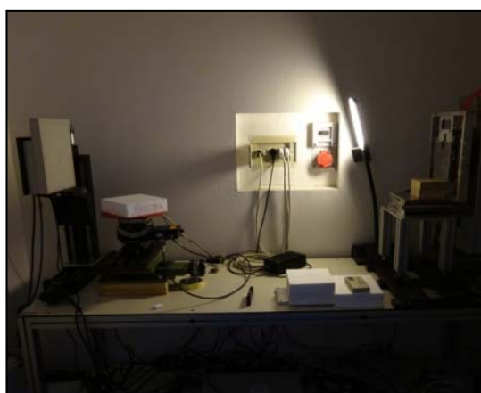
МАТ0002: КТ-визуализация при помощи системы КТ для объектов среднего размера (слева) и системы КТ для крупногабаритных объектов (справа). Фото: М. Грима/Heritage Malta
