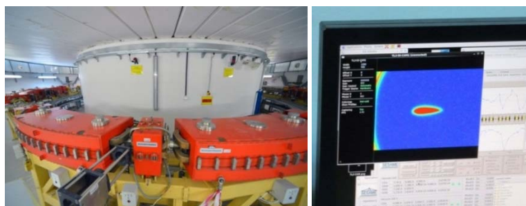
РИС. С-3. Внутреннее накопительное кольцо установки СЕЗАМЕ, отклоняющие и фокусирующие магниты которого обеспечивают управление траекторией движения электронных пучков в процессе их ускорения (слева). Профиль первого пучка, отображенный системой сбора данных на главном пульте управления установки СЕЗАМЕ. (Фото: МАГАТЭ)
