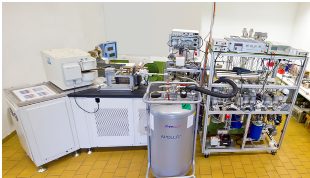
Рис. 4. Анализ инертных газов с помощью масс-спектрометрии
