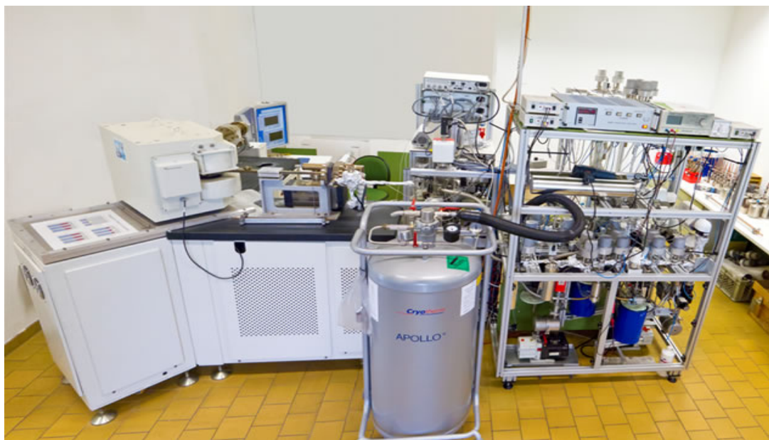
Figure 4 : Spectrométrie de masse en phase gazeuse pour l'analyse des gaz rares
