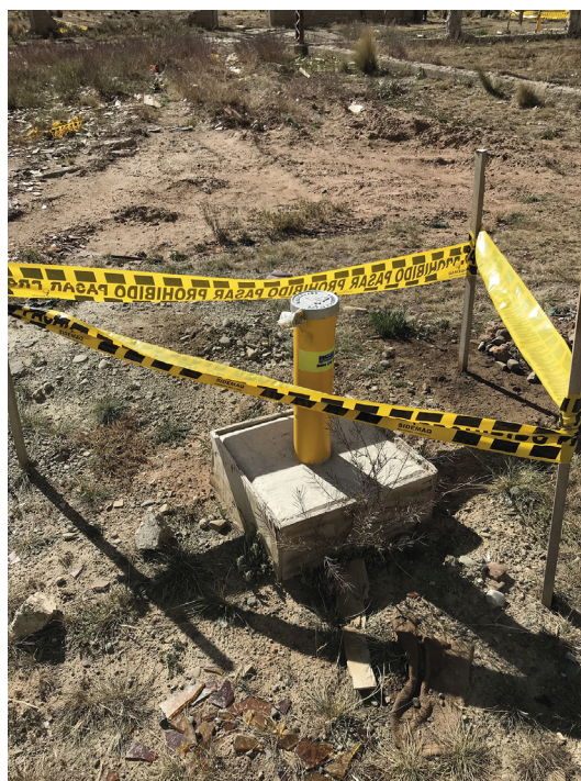
РИС. 1. Одна из нескольких геологических скважин, пробуренных с целью определения характеристик площадки для нового исследовательского реактора мощностью 200 кВт в Эль-Альто, Многонациональное Государство Боливия
