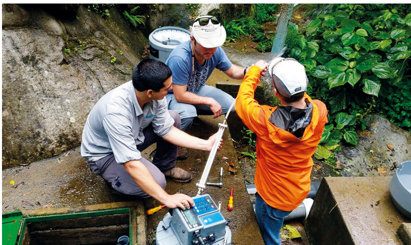
РИС. 1. Практические занятия в Коста-Рике по отбору проб подземных вод для анализа изотопов благородных газов
