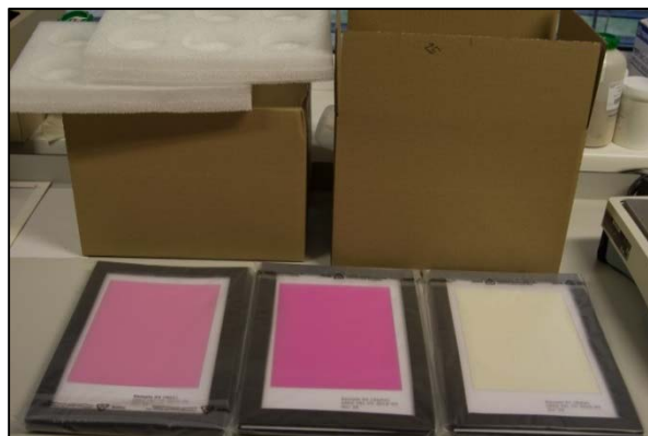
RER7008 : Épreuve de compétence dans le cadre du projet RER7008 : lot de nouvelles matières de référence dont les radionucléides ont été imprimés sur des feuilles dans des couleurs homogènes (chaque couleur correspond à un radionucléide différent). Photo : S. Tarjan (AIEA).
