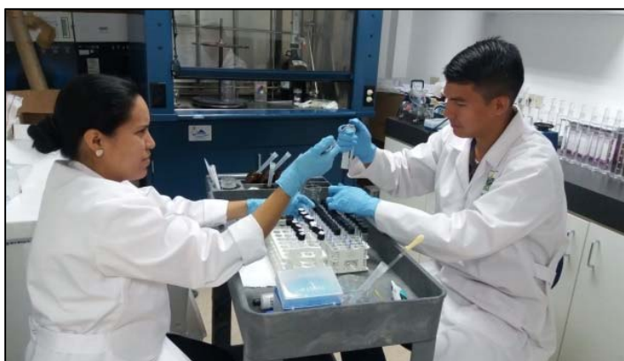
PAN5024 : Des techniciens dosent le glyphosate présent dans l'eau au Laboratoire d'analyse des résidus de pesticides, de la Direction nationale de la protection végétale du Ministère du développement agricole. Photo : Ministère du développement agricole du Panama.
