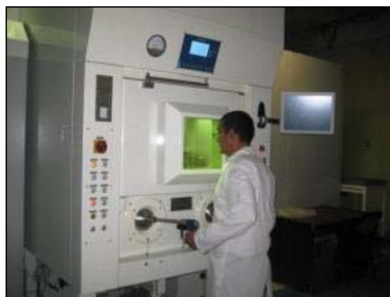
CUB6023 : Nouvelles cellules chaudes achetées avec le concours du projet. Photo : Centre d'isotopes (CENTIS).
