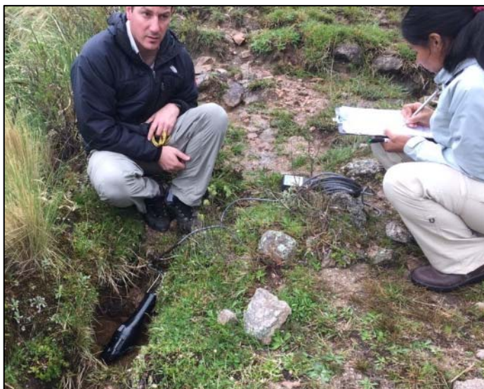
Los Gigantes, dans la province de Córdoba (Argentine). Mesure de paramètres hydrochimiques à l'aide d'une sonde multiparamétrique. Photo : CNEA, Argentine.
