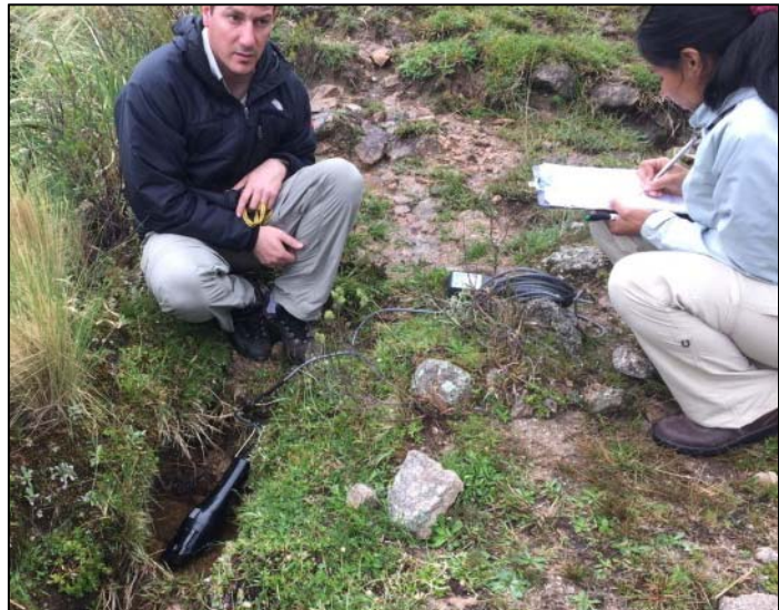
阿根廷科尔多瓦巨人山。用多参数探测器测量水化学参数。照片来源：阿根廷国家原子能委员会。
