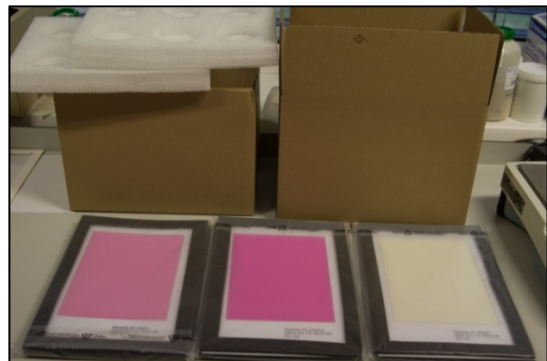
RER7008 号项目：RER7008 号项目下的水平测试：新型基准材料装运，用喷墨打印机将放射性核素单色打印到纸张上（一种颜色代表一种不同的放射性核素）。照片来源：S. Tarjan/原子能机构。
