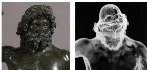
FIG. H-3. D'après cette radiographie, la tête et le tronc de cette statue de Jupiter, qui se trouve à Vieil-Évreux (France), ont probablement été ressoudés. (Photos : J. L. Boutaine)
