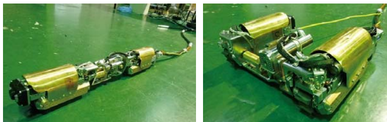
FIG. A-8. Robot à forme adaptable utilisé pour inspecter l'intérieur de l'enveloppe de confinement primaire de la tranche 1.
