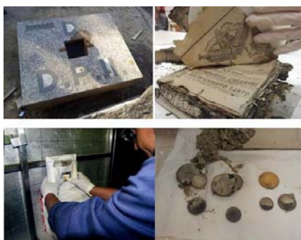
FIG. H-5. Traitement antifongique du coffret mémorial. [Photos : P. Vasquez, Institut de recherches énergétiques et nucléaires IPEN/CNEN, São Paulo, (Brésil)]
