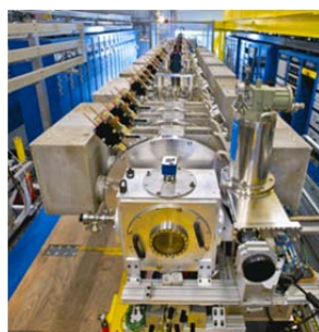
图 C-1. 美国伯克利劳伦斯伯克利国家实验室的 NDCX-II 加速器 12 使得能够进行材料中结构力学研究。图片显示前景处装有靶终端站的 10 米长的加速器（图片：伯克利实验室）。
