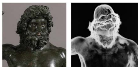
图 H-3. 射线照相表明，位于法国 Vieil-Évreux 的木星雕像的头部和躯干系通过焊接连接（图片：J.L.Boutaine）。
