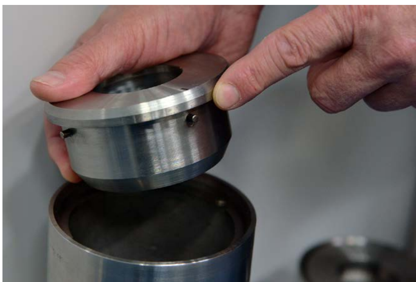
Fig. 1. Un contenedor especial, o bulto de disposición final, para la disposición final en pozos barrenados de fuentes radiactivas selladas en desuso.
