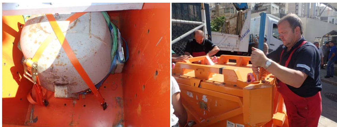
Fig. 2. Preparativos para la retirada de una fuente radiactiva sellada en desuso de la categoría 1 del Líbano.
