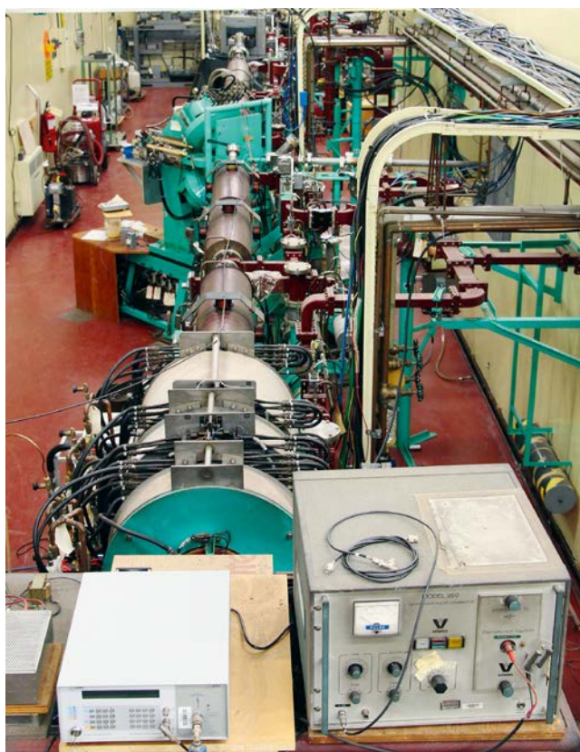
Fig. 1. Acelerador lineal utilizado para producir molibdeno 99 por reacción (\gamma, n) empleando molibdeno 100. (Fotografía cortesía de R. Galea, Consejo Nacional de Investigaciones de Canadá; derechos de autor de la Corona canadiense).
