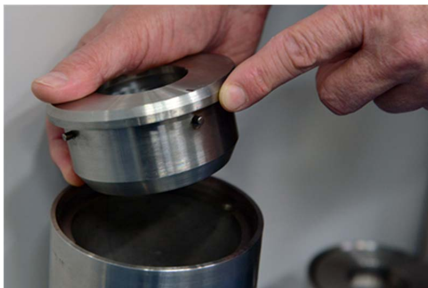
图 1. 用于弃用密封放射源钻孔处置的专门设计密闭容器或处置包。
