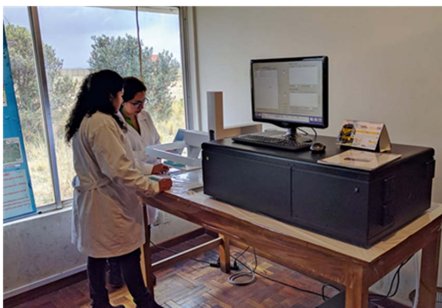
图 1. 作为技术合作项目的一部分，玻利维亚对口方在现场收集地下水样品（上），然后用原子能机构提供的激光分析器进行分析以测量同位素比（下）。
