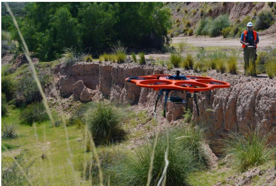
图2. 作为原子能机构用于快速环境监测的无人驾驶飞行器系统的一部分，安装有传感器和摄像机的无人机被用于远程收集数据以准备进行环境治理。
