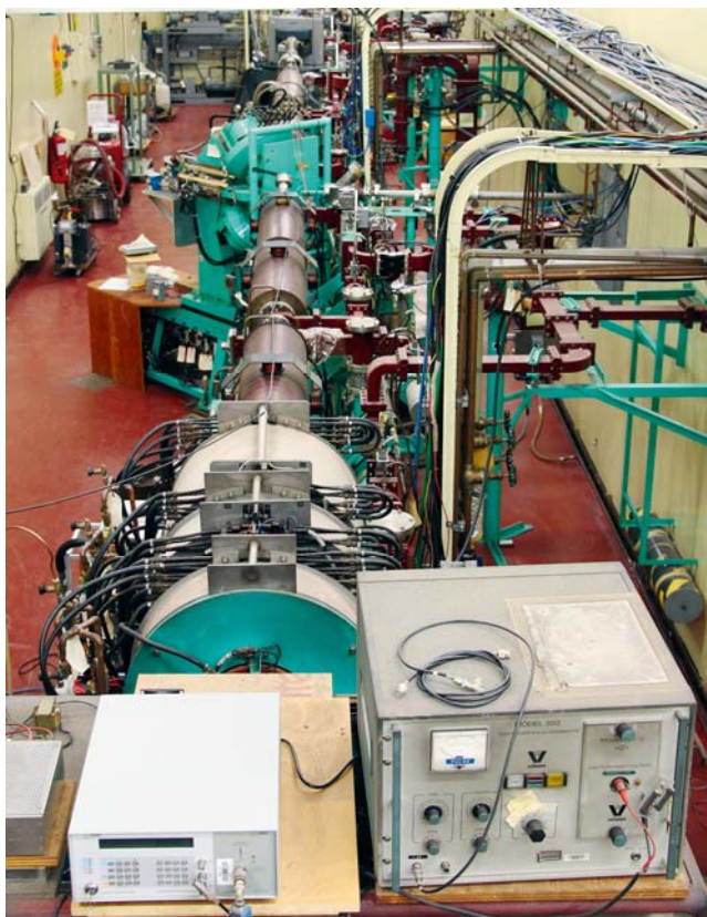
图 1. 用钼-100 (\gamma, n) 反应生产钼-99 的直线加速器。（照片由加拿大国家研究委员会 R. Galea 提供。加拿大皇家版权。）
