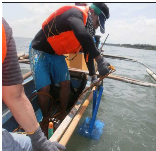
RAS/7/021 : Collecte d'échantillons de sédiments à l'aide d'une benne, détroit de Guimaras, Negros occidental (Philippines). Photo : Institut philippin de recherche nucléaire.
