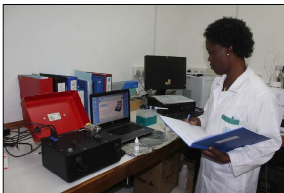
SEY/6/003 : Analyse de l'enrichissement en deutérium par spectroscopie infrarouge à transformée de Fourier.
