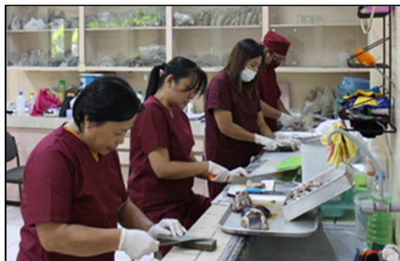
RAS/7/021 : Traitement d'échantillons de poisson aux fins d'analyse par spectrométrie gamma, Institut philippin de recherche nucléaire. Photo : Institut philippin de recherche nucléaire.
