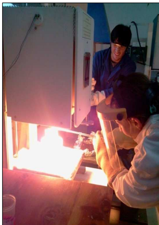
ARG/9/013 : Verre en fusion dans un four électrique dans le cadre de travaux de recherche sur le stockage définitif des déchets radioactifs en toute sécurité, Laboratoire des matières nucléaires, Centre atomique Bariloche. Photo : CNEA.
