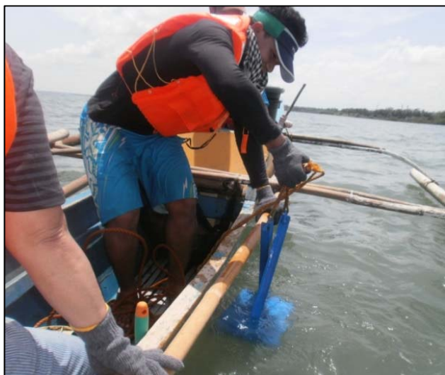
RAS/7/021 号项目：在菲律宾西内格罗斯省吉马拉斯海峡利用抓式取样器收集沉积物样品。图片来源：菲律宾核研究所。
