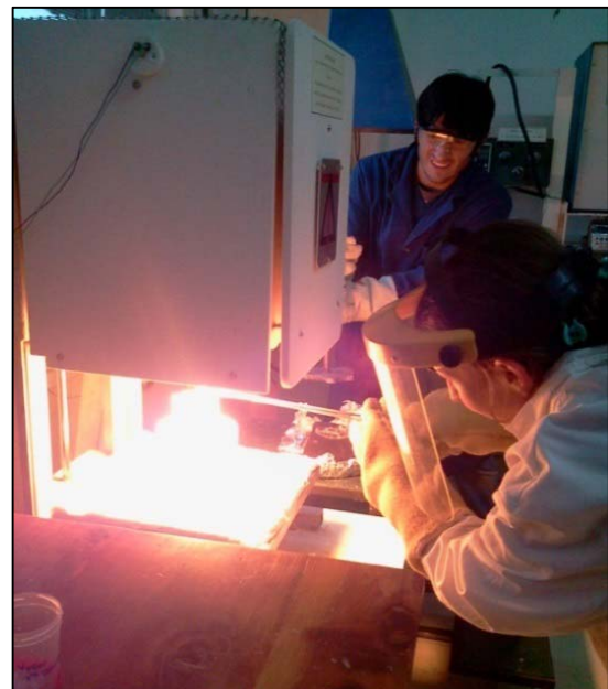
ARG/9/013 号项目：在巴里洛切原子中心核材料实验室，作为安全放射性废物处置研究的一部分，正在电炉中熔化玻璃。照片来源：国家原子能委员会。
