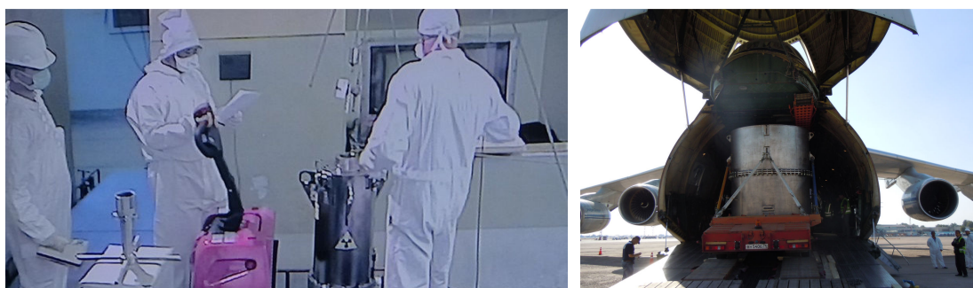
FIG. C-6. Conteneur de transport de combustible liquide à l'UHE irradié (à gauche). Le camion transportant le conteneur de combustible liquide à l'UHE est acheminé dans l'avion-cargo qui rapatrie le combustible du réacteur FOTON IIN-3M en Ouzbékistan vers la Fédération de Russie (à droite).
