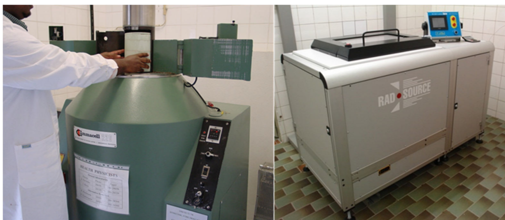
FIG. F-4. Des irradiateurs à rayons gamma (à gauche) ou à rayons X (à droite) sont utilisés pour stériliser les moustiques mâles. (Photo : AIEA)
