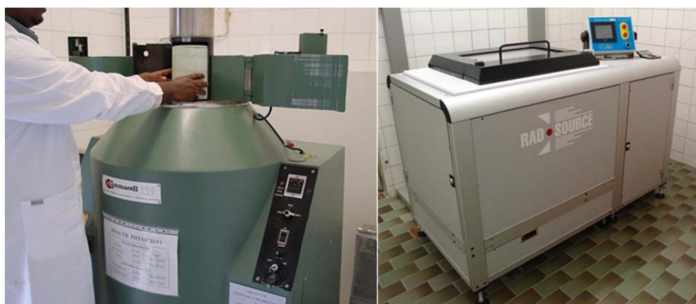
图 F-4. \gamma 射线 (左) 或 X 射线 (右) 辐照器用于雄蚊的绝育。(照片由原子能机构提供)
