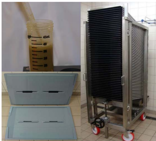
图 F-2. 为规模饲养幼虫期蚊虫而开发的液体幼虫饲料、托盘和支架。(照片由原子能机构提供)
