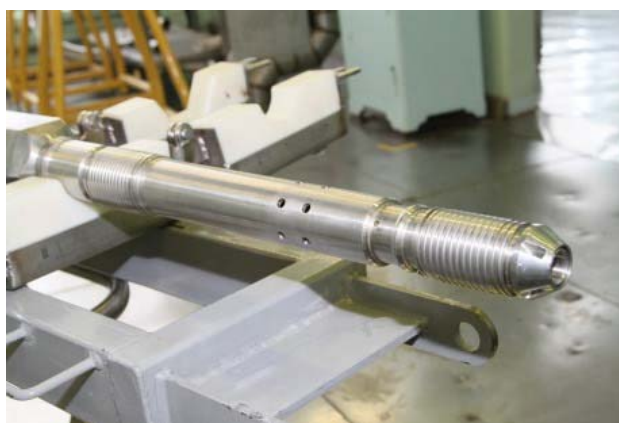
Fig. A-7. Conjunto combustible TVS-5, el prototipo de combustible para el reactor avanzado BREST-300. (Fotografía: Grupo Siberiano de Empresas Químicas).
