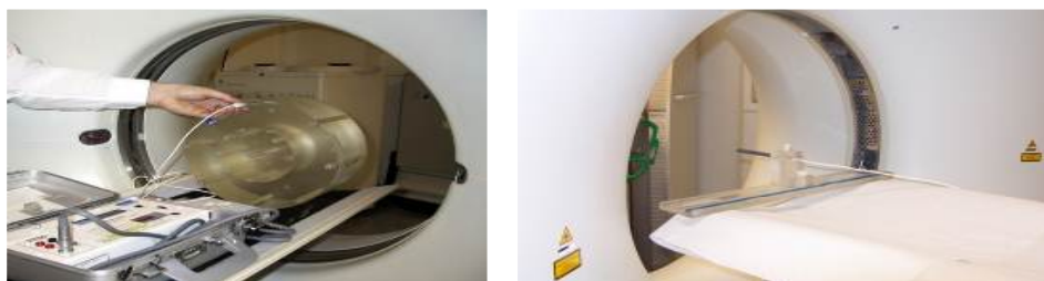
Fig. E-1. Medición de la dosis en TC en un maniquí estándar de polimetil metacrilato y en aire.
