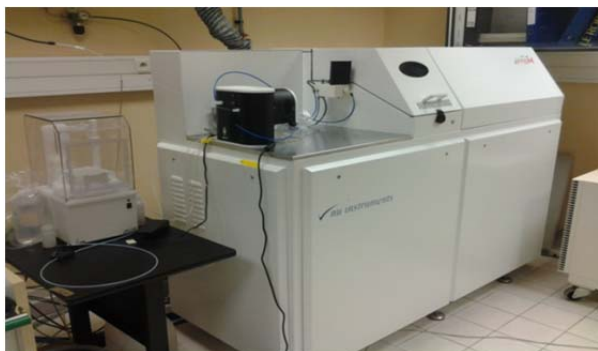
Fig. H-3. Espectrómetro de masas con plasma acoplado inductivamente de alta resolución que se utiliza para analizar los isótopos estables del plomo en muestras ambientales.
