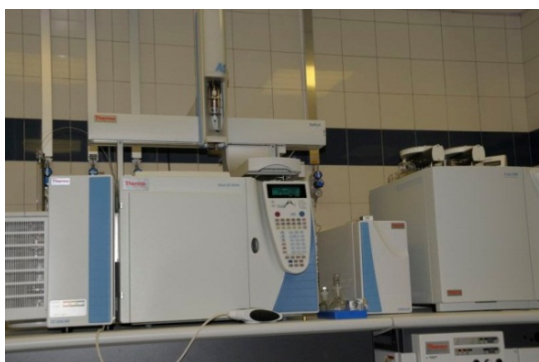
Fig. H-2. Espectrómetro de masas de relaciones isotópicas que se utiliza para medir las razones de los isótopos estables del nitrógeno y el carbono en el estudio de los procesos de eutrofización costera.
