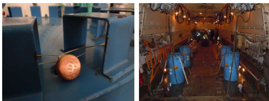
FIG. C-4. Scellés de contrôle de l'Agence sur un conteneur de transport TK-S16 (à gauche). Conteneurs de transports préparés pour le vol d'Almary (Kazakhstan) en Fédération de Russie (à droite).
