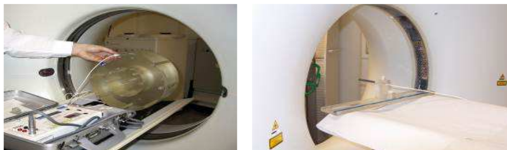
FIG. E-1. Mesure de doses en CT dans un fantôme classique en polyméthacrylate de méthyle simulant le corps humain et dans l'air.
