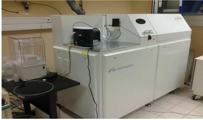
FIG. H-3. Spectromètre de masse haute résolution à plasma à couplage inductif servant à analyser les isotopes stables du plomb dans des échantillons de l'environnement.
