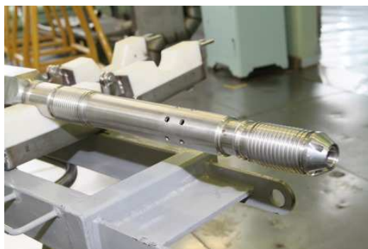
FIG. A-7. Assemblage combustible TVS-5, le prototype de combustible pour le réacteur avancé BREST-300. (Photo : SCC)
