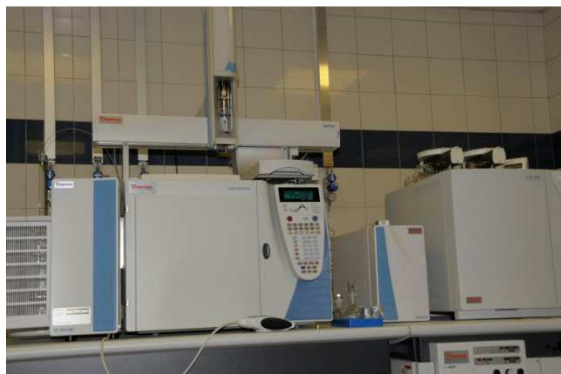
FIG. H-2. Spectromètre de masse à rapport isotopique servant à mesurer les rapports des isotopes stables de l'azote et du carbone pour l'étude des processus d'eutrophisation des régions côtières.
