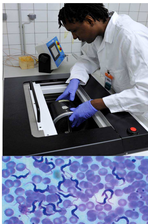
FIG. D-1. Irradiation de cultures in vitro de trypanosomes ( T. evansi ) avec une source de rayons X.
