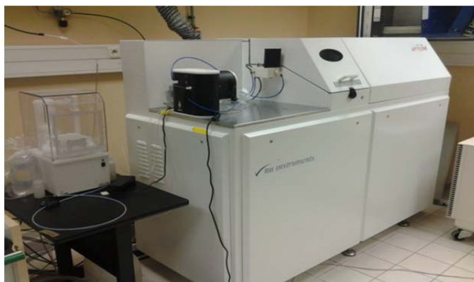
الشكل هاء-٣ - مطياف كتلي بلازمي مقرون بالحث وعالي الدقة يُستخدم لتحليل النظائر المستقرة للرصاص في العينات البيئية
