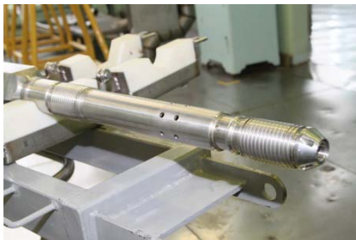
الشكل ألف-٧- مجمعة وقود TVS-5، النموذج الأولي لوقود المفاعل السريع المأمون ضمنياً المتقدّم طراز BREST-300 (الصورة من: المجمع الكيميائي السيبيري)
