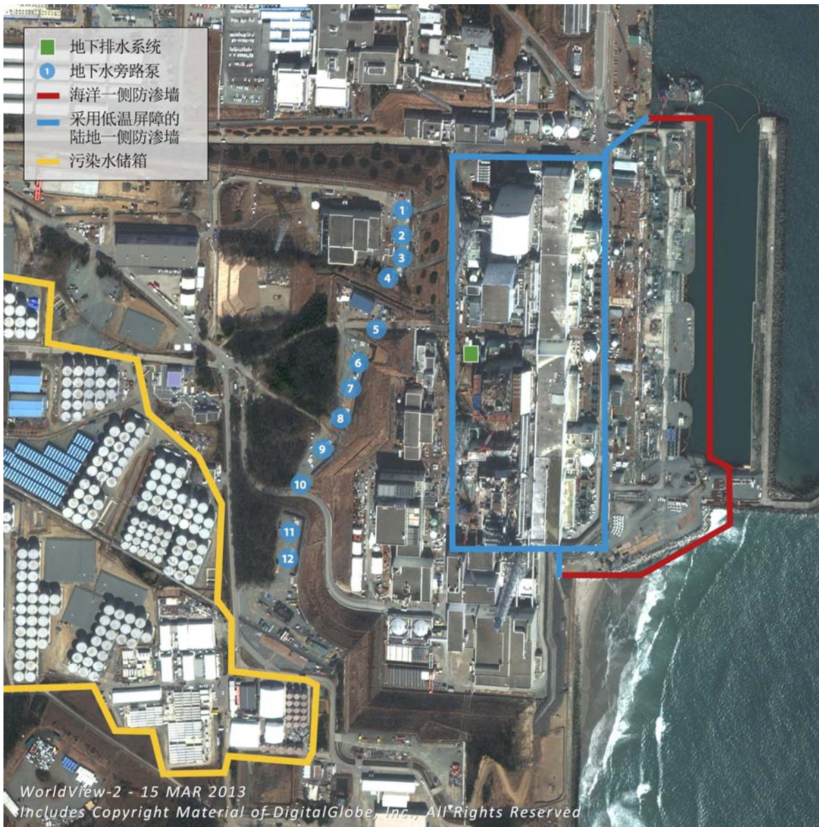
图 5.5. 水管理工作示意图。左侧所示为污染水储箱[286]。
