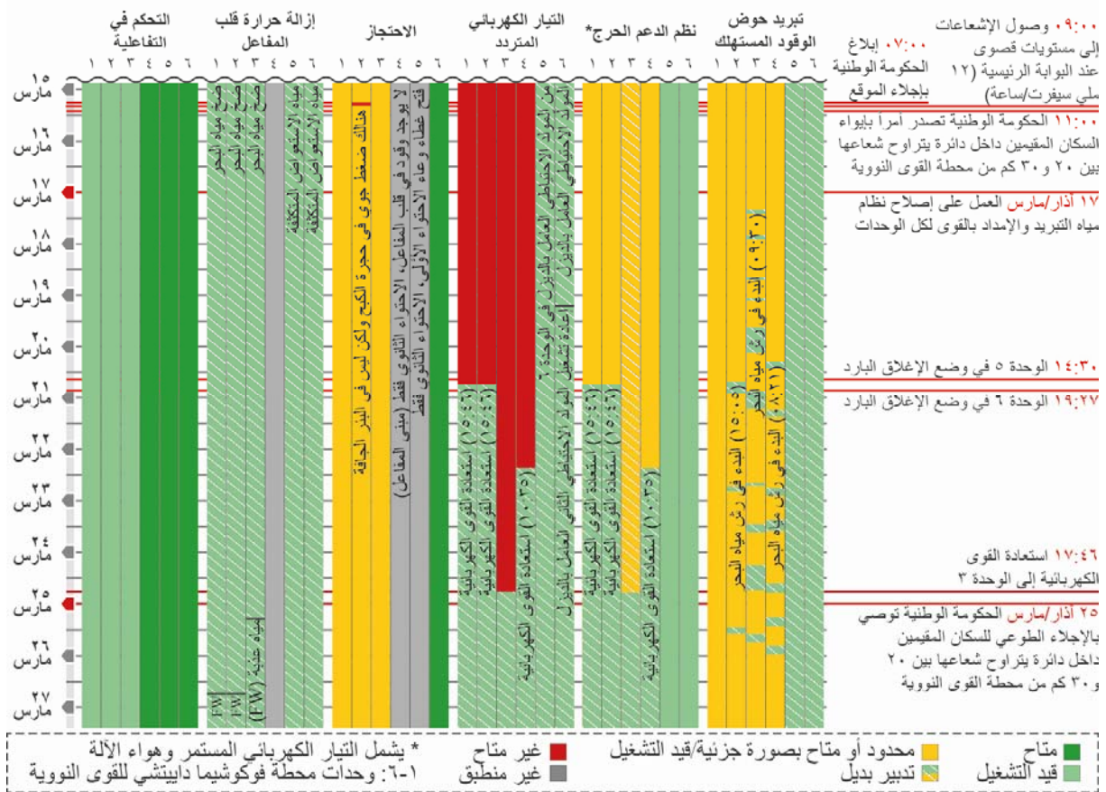
الشكل ٦-٢: استعادة وظائف الأمان الأساسية مؤقتاً في محطة فوكوشيما دايبنتشي للقوى النووية.
