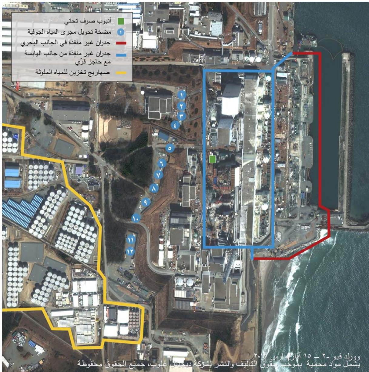
الشكل ٥-٥- صورة توضيحية للجهود المعنية بالتصرف في المياه. وتظهر في الجانب الأيسر صهاريج تخزين المياه الملوثة [286].
