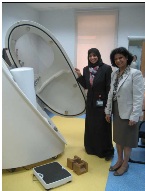
BKF/6/001 : Installation de l'appareil BOD POD de mesure de la graisse corporelle par densitométrie.
