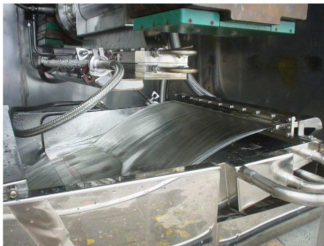
Fig. F-1. Traitement des eaux usées avec un accélérateur de faisceaux d'électrons. (Photo : Eb Tech, République de Corée)
