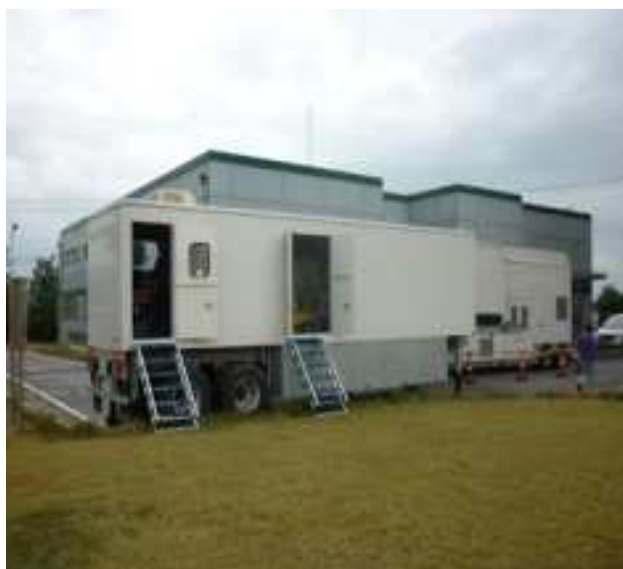
Fig. F-2. Accélérateur de faisceaux d'électrons mobile installé dans une usine de traitement des eaux usées. (Photo: KAERI)
