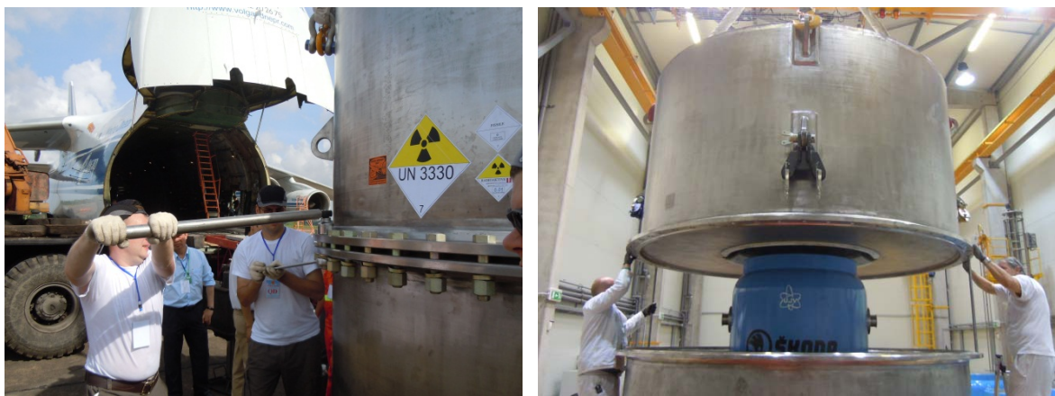
图 C-5. 左图：紧固装载越南大勒核研究所至俄罗斯联邦高浓铀乏燃料特种运输包装件上的螺栓。右图：在匈牙利布达佩斯研究堆高浓铀乏燃料运输屏蔽容器上加装保护性外包装。该外包装被设计成能允许航空运输。
