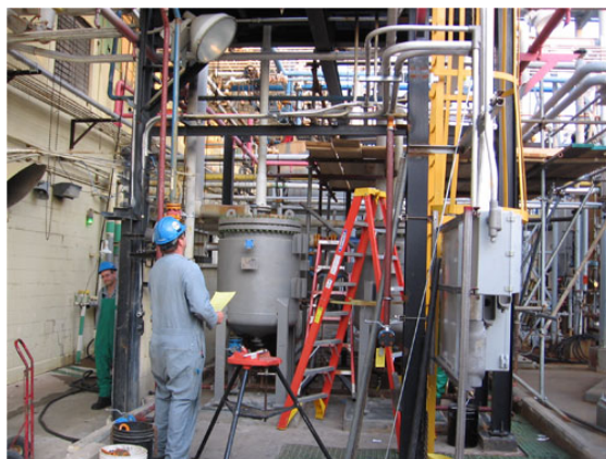
图 A-10. 美国伊利诺伊州霍尼韦尔大都会工程设施的新氟化氢气化器（照片由 Coverdyn 提供）。
