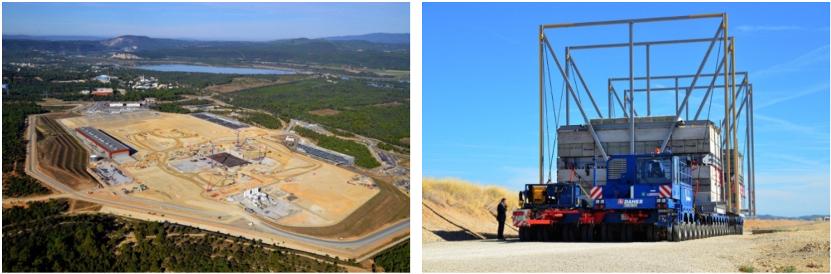
图 B-4. 国际热核实验堆场址 2013 年 9 月的状况（左）。模仿国际热核实验堆最大载荷重量和尺寸（高 10 米、长 33 米、宽 9 米）有遥控车辆跟随的 800 吨拖车连续四个晚上以每小时 5 公里平均速度行驶，以测试 104 公里长的“特别行程”（右）（照片由国际热核实验堆提供）。
