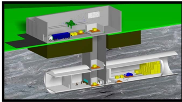
图 A-15. 在俄罗斯联邦规划的低放废物处置设施进行置入作业的概念（绘图由全俄综合电力技术设计和研究所提供）。
