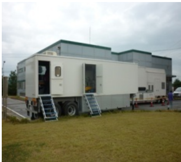
图 F-2. 安装在污水处理厂的移动式电子束加速器（照片由韩国原子能研究院提供）。
