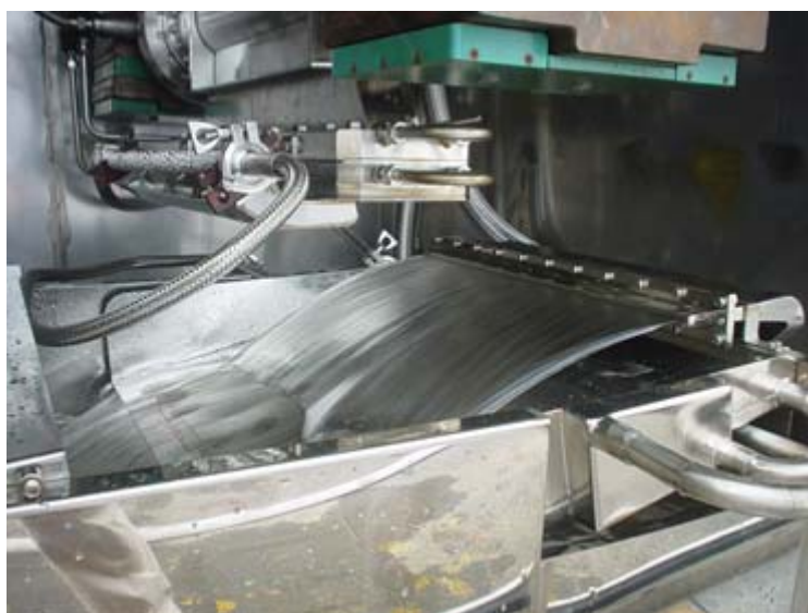
图 2. 对工业废水进行电子束处理，以便能够更安全地对其进行处置（照片由 EBTech 公司提供）。
