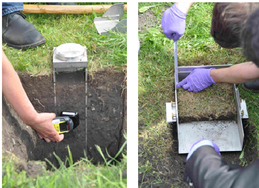
图3. 正在进行用于环境放射性核素分析的土壤取样技术的培训。
