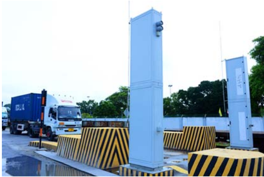
图 1. 泰国和马来西亚边境的门式辐射监测器。该装置实时探测辐射而不中断正常的进出口业务。
