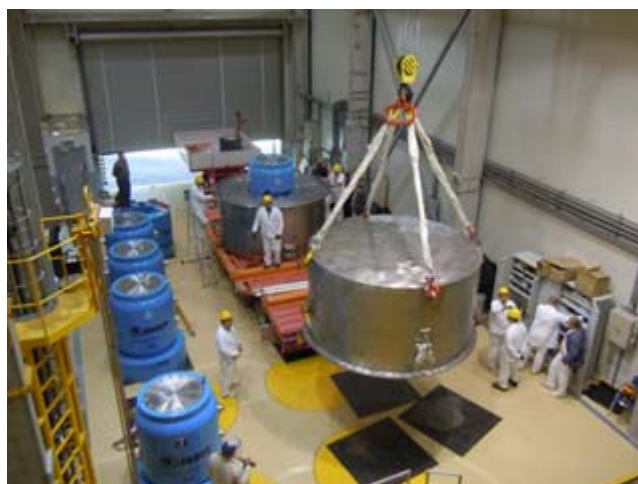
图 2. 正在将原子能机构采购的两用屏蔽容器（蓝色）装入 TUK-145/C 型运输货包，以返还位于中央物理学研究院原子能研究所布达佩斯研究堆场址上的高浓铀乏燃料。
