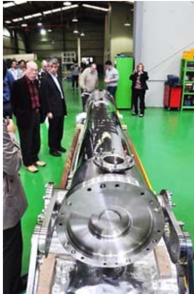
图 3. “乏燃料性能评估和研究”协调研究项目参与者在韩国原子能研究院视察“DrySim 6”干法贮存模拟试验设备（照片由工程、设计和研究组织提供）。
