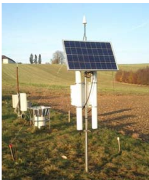
图 2. 位于奥地利佩岑基兴的宇宙射线土壤水分系统。
