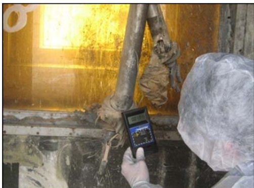
IRQ/9/007 e IRQ/9/009: Caracterización radiológica de las celdas calientes y el tanque de desechos.
