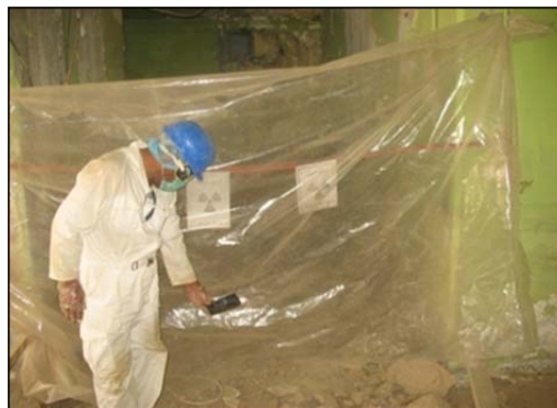
IRQ/9/007 e IRQ/9/009: Caracterización radiológica de las celdas calientes y el tanque de desechos.
