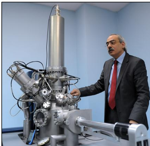
LEB/2/007: TOF-SIMS utilizada para efectuar análisis superficiales elementales, químicos y estructurales de materiales biológicos y orgánicos.
