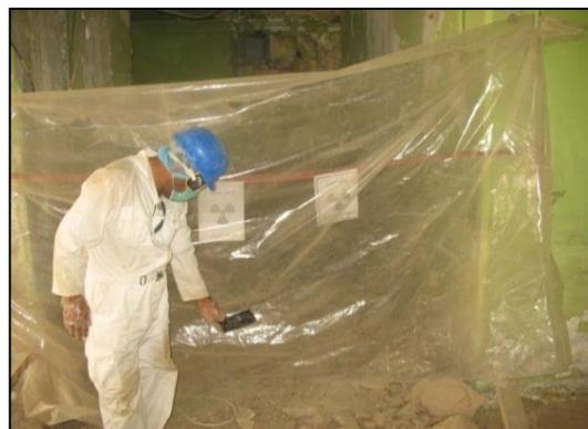
IRQ/9/007 и IRQ/9/009: определение радиологических характеристик горячих камер и емкостей для отходов.
