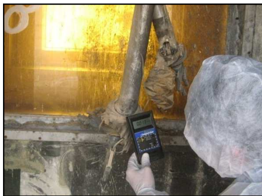
IRQ/9/007 et IRQ/9/009 : Caractérisation radiologique pour les cellules chaudes et les cuves de déchets.
