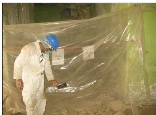
IRQ/9/007 et IRQ/9/009 : Caractérisation radiologique pour les cellules chaudes et les cuves de déchets.
