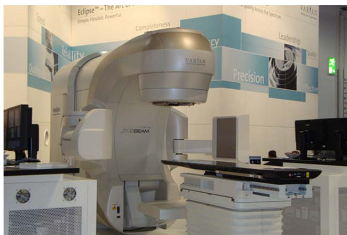
Fig. E-1. Acelerador lineal moderno equipado para IGRT. Este dispositivo permite aumentar la precisión de la radioterapia mediante la obtención frecuente de imágenes del blanco y/o los tejidos sanos justo antes del tratamiento y actuar en función de esas imágenes a fin de adaptar el blanco sometido a radiación. Fotografía: Eduardo Rosenblatt. Foro de la ESTRO, Londres 2011.
