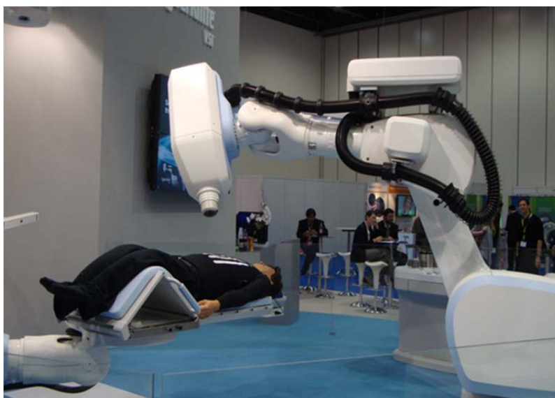
Fig. E-2. La radioterapia robótica es un sistema de radiocirugía robótica sin marco. Los dos principales elementos de este dispositivo son la radiación producida por un pequeño acelerador lineal, y un brazo robótico que permite dirigir la energía hacia cualquier parte del cuerpo desde cualquier dirección. Fotografía: Eduardo Rosenblatt. ESTRO Forum London 2011.
