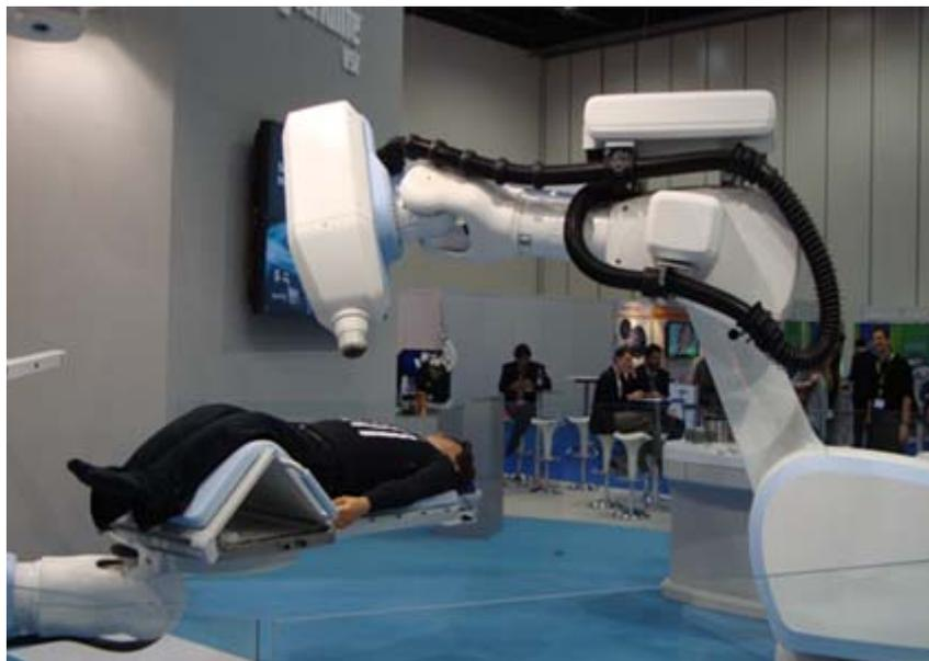
*РИС. Е-2. Роботизированная лучевая терапия - это безрамная система роботизированной радиохирургии. Двумя главными компонентами этого аппарата являются небольшой линейный ускоритель для облучения и роботизированная рука-манипулятор, позволяющая направлять энергию на любую часть тела с любого направления. Фото: Eduardo Rosenblatt. ESTRO Forum, London 2011.*
