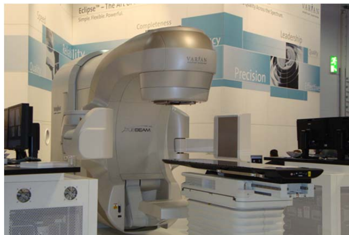
FIG. E-1. Accélérateur linéaire médical moderne équipé pour l'IGRT. Ce dispositif permet d'accroître la précision des radiothérapies grâce à des images fréquentes de la cible et/ou des tissus sains juste avant le traitement, et d'adapter la cible des rayonnements grâce à ces images. Photo : Eduardo Rosenblatt. Forum de l'ESTRO, Londres 2011.
