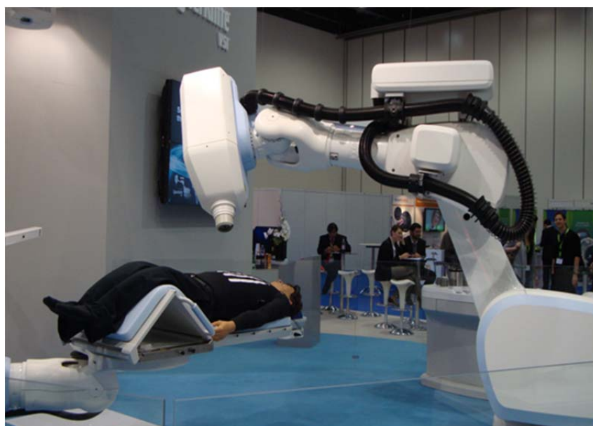
FIG. E-2. La radiothérapie robotisée est un système de radiochirurgie robotisée sans cadre. Les deux principaux éléments du dispositif sont le rayonnement produit par un petit accélérateur linéaire et un bras robotisé qui permet de diriger l'énergie de n'importe quelle direction vers n'importe quelle partie du corps. Photo: Eduardo Rosenblatt. Forum de l'ESTRO, Londres 2011.
