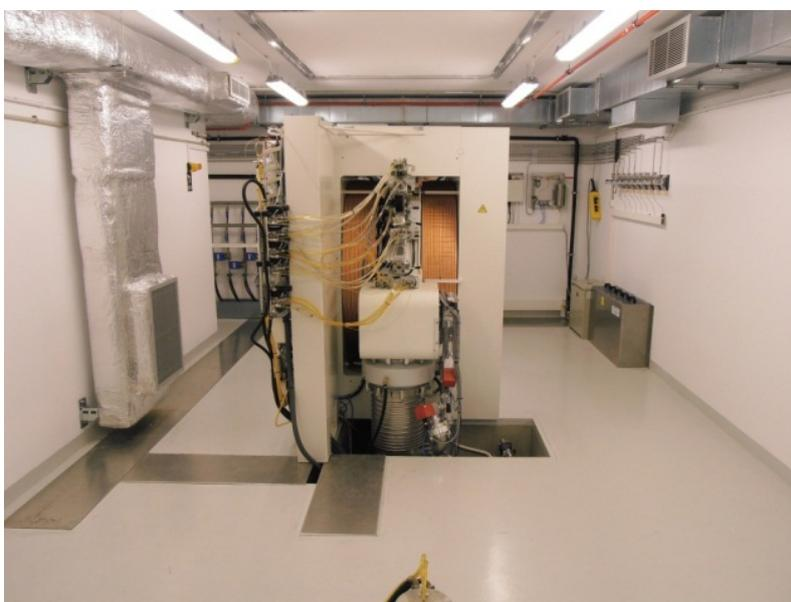
*РИС. 2. Циклотронная установка по производству радиофармацевтических препаратов ПЭТ в Польше*
