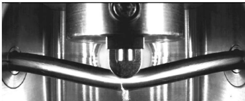
*РИС. 3. Моментальный снимок испытаний топливного стержня на механическую прочность.*
