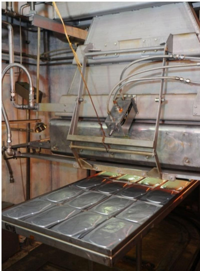
*РИС. 3. Радиационная обработка (сшивание и стерилизация) нанокompозитных биоогидрогелей для биомедицинских применений в Малазийском ядерном агентстве.*
