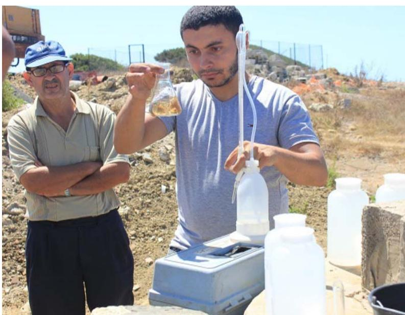
*РИС. 1. Изучение скорости инфильтрации дождевой воды для искусственного пополнения подземных вод в водоносных горизонтах Марокко.*
