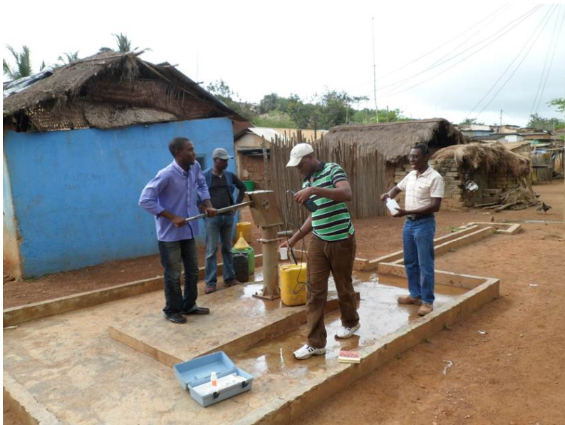
الشكل ٢ - حملة لأخذ العينات من أجل تحليل نظيري وهيدروكيميائي للمياه الجوفية جنوبي غانا.
