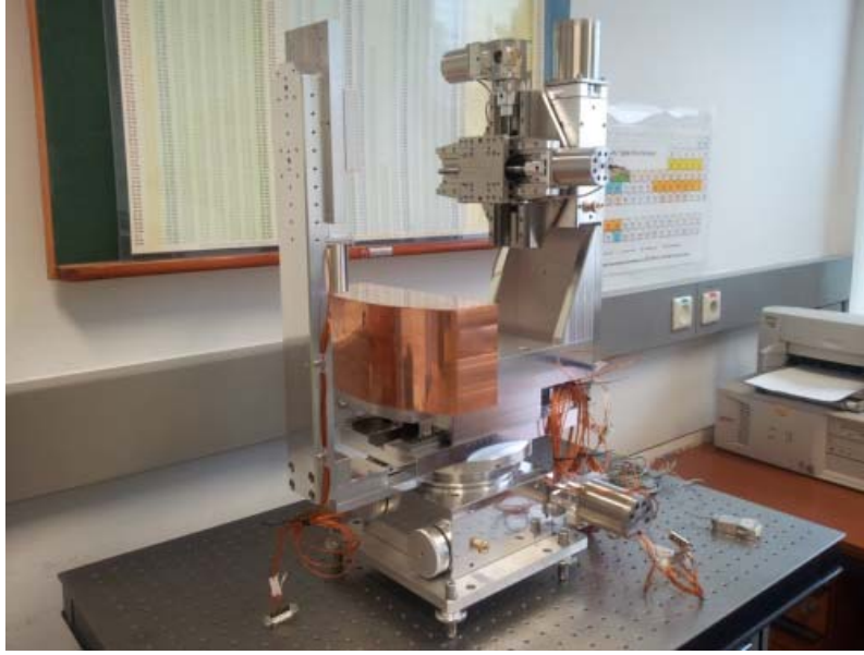
الشكل-٤- صورة جهاز مناولة العينات ذي المحرك السباعي المحاور المركب في الحجرة الفائقة الفراغ في مختبر الوكالة لقياس الطيف النووي والتطبيقات النووية.
