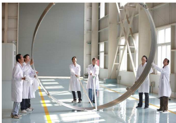
Fig. B-2. Izado de las bobinas superconductoras de corrección de campo que se utilizarán en el ITER, Instituto de Física del Plasma, Hefei (China).
