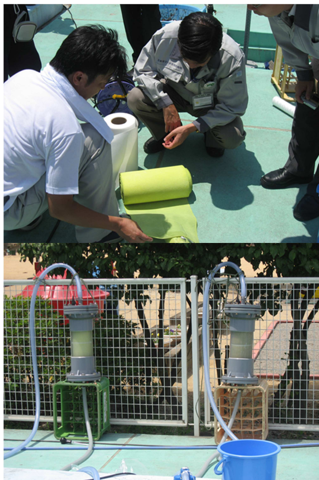
Fig. H.1. Utilización membranas con injertos para retirar el radiocésio del agua en la zona de Fukushima (fotografía por cortesía del JAEA Takasaki, Japón).
