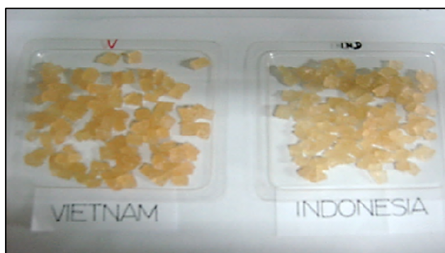
Almidón de mandioca+KOH+ácido acrílico tras su irradiación y secado en una preparación de superabsorbentes de agua.
