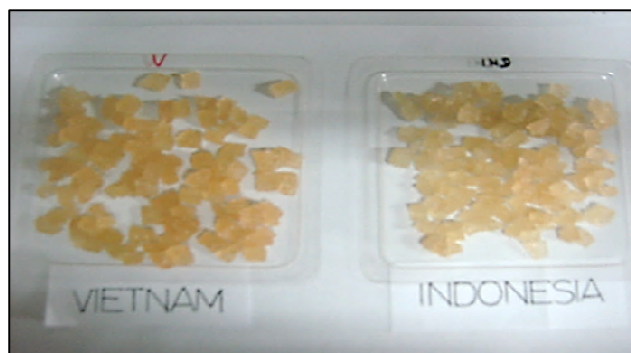
Amidon du manioc + KOH + acide acrylique après irradiation et séchés pour la préparation de super-absorbants d'eau.
