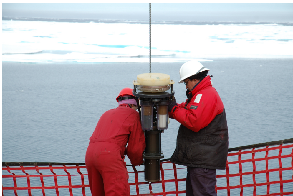
РИС. G-2. Установка насоса большого объема для сбора материала в виде частиц, используемого с целью измерения радионуклидов в арктических водах.
