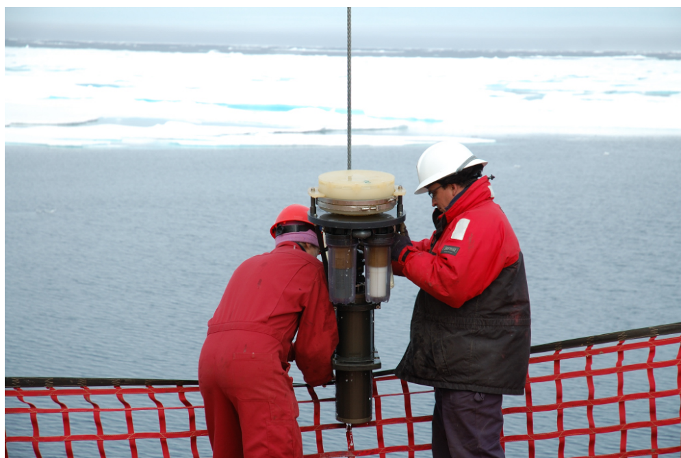
FIG. G-2. Mise en place in situ d'une pompe à grand volume en vue de collecter des particules de matières utilisées pour mesurer les radionucléides dans les eaux arctiques.
