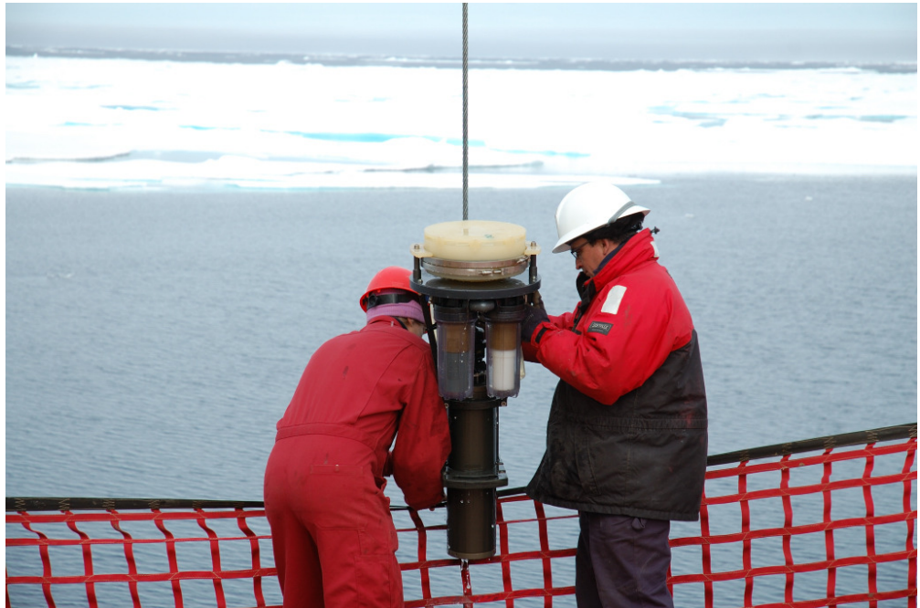
الشكل زاي-٢. تركيب مضخة موقعية كبيرة الحجم لجمع المواد الجسيمية المستخدمة لقياس النويدات المشعة في مياه البحر المتجمد الشمالي.
